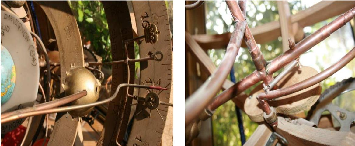
La came le galet & le levier actionneur des indicateurs du temps vrai
